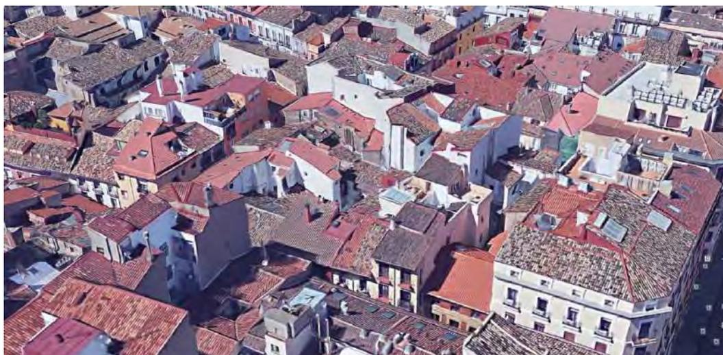
Figura 45. Ejemplo de disposición de cubiertas inclinadas con diferentes orientaciones y alturas lo que dificulta seriamente la instalación de colectores solares; este es el caso de la zona del casco histórico. (Ref: Google earth).
